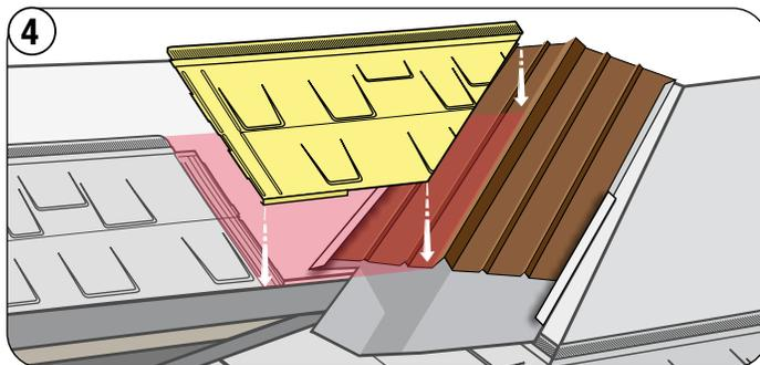
4 Instale el panel cortado sobre el Valle. Fíjese que el gancho de la punta entrelazada del panel debe estar entallado para permitir el drenaje del Valle. [Ver página 13, Paso 3 para más detalles.](#)
