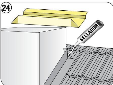
24 Aplique sellador abajo en ambos lados del panel en línea con la Chimenea / Tragaluz.
