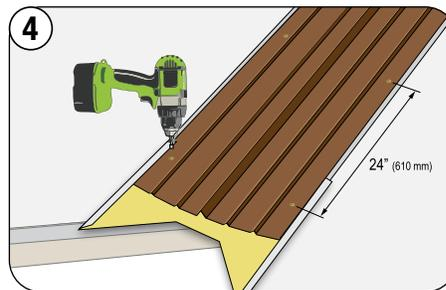
Inserte el valle cinco "V" en la salida del valle. Fije el valle con tornillos de arandela y ojal en las ubicaciones exteriores a un mínimo de 24 pulg entre centros (610 mm) por ambos lados.
