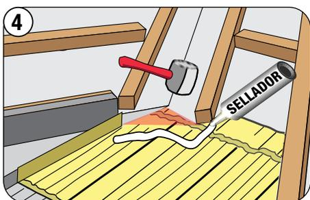
4 Instale el panel de salida del valle para que encaje bajo el voladizo del alero de la buhardilla y la salida del valle. Aplane la brida trasera contra el entablado del techo y aplique el sellador, tal como se muestra.
